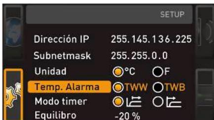
Aquí puede ajustar qué tipo de clase de protección térmica según DIN 12 880:2007-5 (TWW o TWB) se va a utilizar (descripción en ▶6.6 Función de supervisión).
