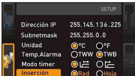
Aquí debe ajustar qué tipo de elemento insertable (rejilla o bandeja) se utiliza. La opción **Bandeja** permite adaptar la función de regulación al variado comportamiento del flujo en el interior cuando se utilizan bandejas insertables opcionales en lugar de las rejillas incluidas en el volumen de suministro estándar.
