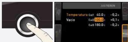
2. Pulse repetidamente el botón de confirmación hasta que se marque la temperatura de referencia Cal2.
