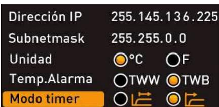
Aquí se puede ajustar si el reloj digital marcha atrás con indicación de la hora objetivo (véase ▶6.5.2 Reloj digital marcha atrás) debe funcionar o no en función del valor de consigna, es decir, si el tiempo de funcionamiento del temporizador debe iniciarse solo cuando se alcance la correspondiente banda de tolerancia en torno a la temperatura de consigna Ⓑ o inmediatamente después de que se active el temporizador Ⓐ.
