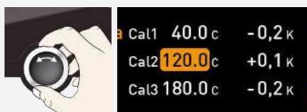
3. Ajuste la temperatura de referencia Cal2 a la temperatura especificada mediante el botón giratorio.
