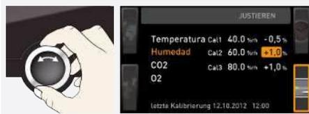
6. Ajuste el valor de corrección de ajuste a 0,0 %.
