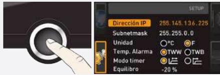
5. Confirme la nueva dirección IP después de configurar el último bloque de dígitos con el botón de confirmación.
