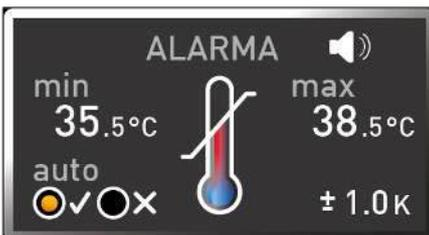
La temperatura de supervisión de la supervisión electrónica de la temperatura se mide mediante un sensor de temperatura Pt100 independiente situado en el interior. Los ajustes de supervisión de la temperatura se realizan en la indicación **ALARM**. Los ajustes realizados son efectivos en todos los modos de funcionamiento.
