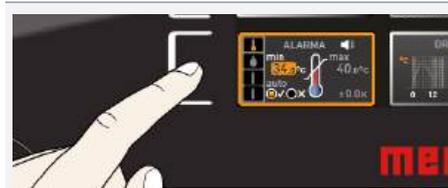
1. Pulse el botón de activación situado a la izquierda de la indicación **ALARM**.
