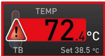
El equipo dispone de un limitador mecánico de la temperatura (TB) clase de protección 1 según DIN 12880.
