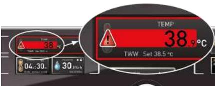
Si se ha activado una supervisión de temperatura, esto se informa a través de la indicación de la temperatura: mediante la temperatura real resaltada en rojo y un símbolo de alarma
