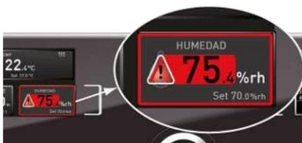
Si se ha activado la supervisión del nivel de humedad, esto se informa a través de la indicación de la humedad: mediante la humedad real resaltada en rojo y un símbolo de alarma ▲.
