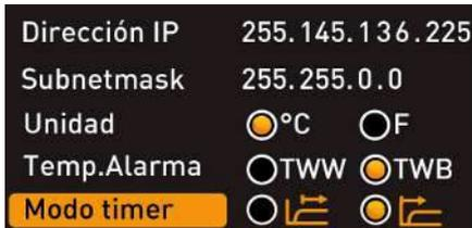
Aquí se puede ajustar si el reloj digital marcha atrás con indicación de la hora objetivo (véase ▶6.5.2 Reloj digital marcha atrás) debe funcionar o no en función del valor de consigna, es decir, si el tiempo de funcionamiento del temporizador debe iniciarse solo cuando se alcance la correspondiente banda de tolerancia en torno a la temperatura de consigna ⑥ o inmediatamente después de que se active el temporizador ④.
