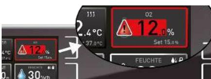
Si se ha activado la supervisión del O<sub>2</sub>, esto se informa a través de la indicación del O<sub>2</sub>: mediante el valor real resaltado en rojo y un símbolo de alarma
