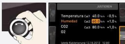
4. Ajuste el punto de referencia Cal2 a 60 % hr mediante el botón giratorio.
