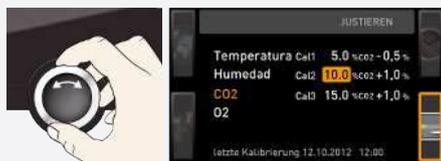
4. Ajuste el punto de referencia Cal2 a 10 % mediante el botón giratorio.
