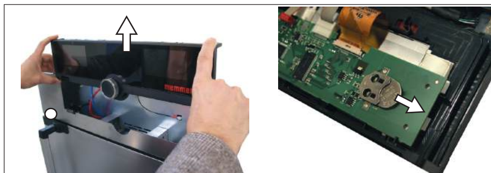
Fig. 29 Retirar la batería de litio
