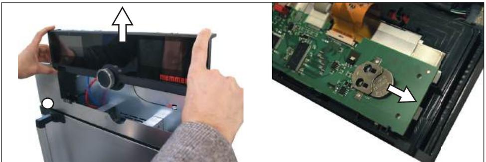
Fig. 25 Retirar la batería de litio
