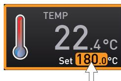
3. Guarde el valor configurado presionando la tecla de confirmación. El indicador vuelve al estado normal y el equipo inicia el proceso de ajuste conforme al valor configurado.
