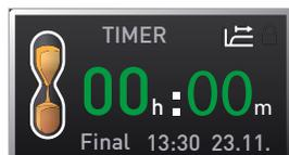
Para desactivar el temporizador, vuelva a acceder al modo de ajuste del temporizador presionando la tecla de activación, gire el botón giratorio hasta que el tiempo de funcionamiento sea --:-- y, a continuación, acepte con la tecla de confirmación.
