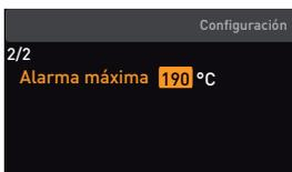
7. Gire el botón giratorio para seleccionar la nueva temperatura de activación deseada (en el ejemplo 160 °).
