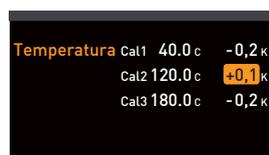
5. Ajuste el valor de compensación a 0.0 K y guarde la configuración presionando la tecla de confirmación.
