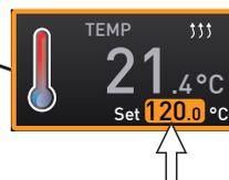
8. Espere hasta que el equipo alcance la temperatura nominal y se muestre 120 °C. La sonda de referencia muestra el valor registrado: 122,6 °C.
