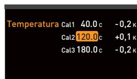
4. Guarde la configuración presionando la tecla de confirmación. A continuación se resalta el valor de compensación correspondiente de forma automática.
