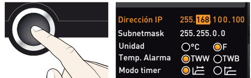
5. Cuando se termine la configuración del último bloque de cifras, acepte la dirección presionando la tecla de confirmación. La marca en color volverá a pasar a la vista general.
