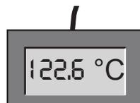
9. Ajuste el valor de compensación de Cal2 a +2,6 K (el valor real registrado menos el valor nominal) y guarde la configuración presionando la tecla de confirmación.
