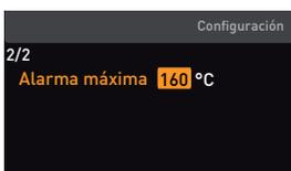
8. Guarde la configuración presionando la tecla de confirmación. En adelante, el sistema de vigilancia electrónica de la temperatura reaccionará cuando la temperatura real alcance el valor de 160 °C.
