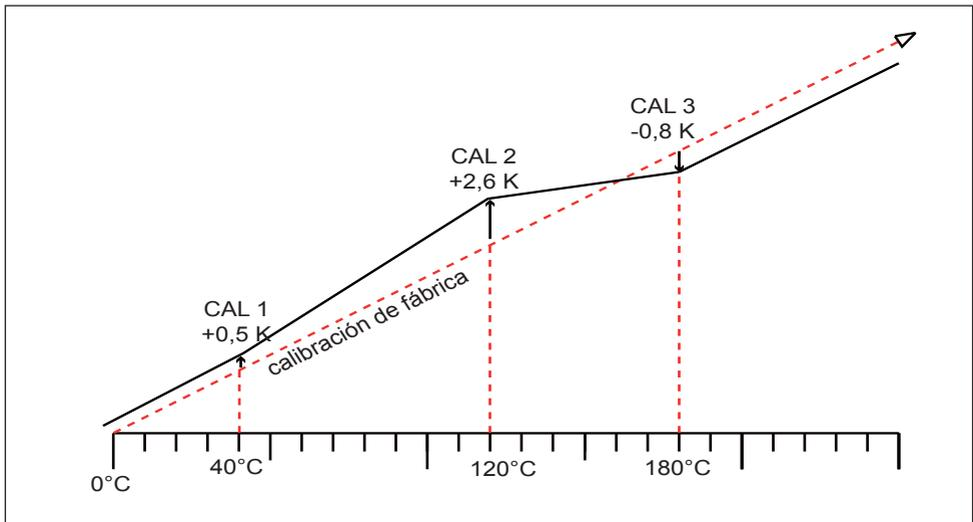
Fig. 24 Ejemplo esquemático del ajuste de rectificación de la temperatura
