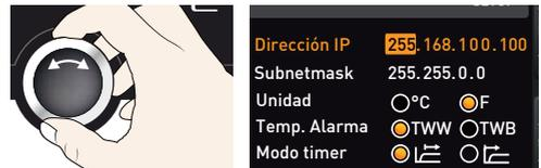
4. Acepte la selección con la tecla de confirmación. El siguiente bloque de cifras de la dirección IP se marca de forma automática. Este se puede ajustar con el botón giratorio de la misma forma que se acaba de describir.
