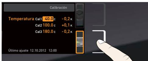
2. Presione la tecla de confirmación varias veces hasta que se resalte la temperatura de compensación Cal2.
