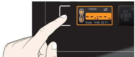
2. Gire el botón giratorio hasta visualizar el tiempo de funcionamiento deseado – (en el ejemplo, 4 horas y 30 minutos–). Debajo se muestra en menor tamaño la hora de finalización prevista según los cálculos.
