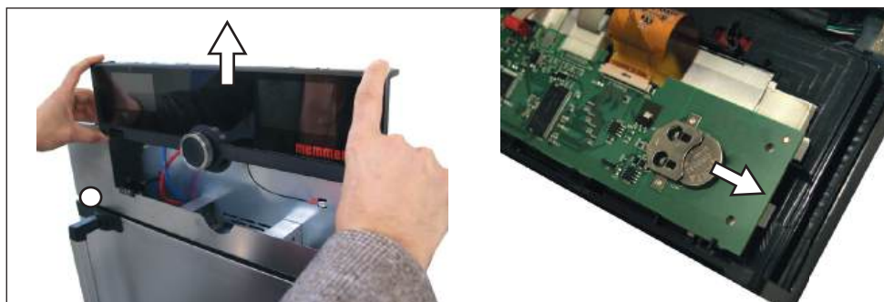
Fig. 29 Retirar la batería de litio
