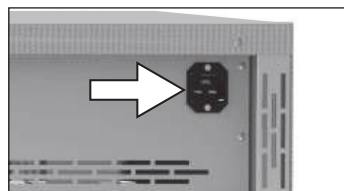
Fig. 11 Conexión de red de 230/115 V
