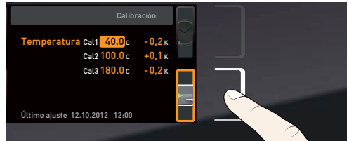
Fig. 27 Ejemplo esquemático del ajuste de rectificación de la temperatura
