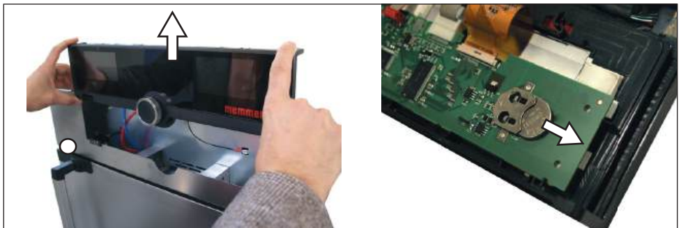
Fig. 22 Quitando la batería de litio
