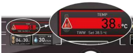
Si se ha activado una supervisión de temperatura, esto se informa a través de la indicación de la temperatura: mediante la temperatura real resaltada en rojo y un símbolo de alarma ▲. Debajo se muestra qué tipo de supervisión de temperatura se ha activado (véase ▶7 Averías, mensajes de advertencia y error).
