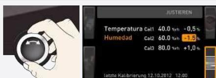
12. Ajuste el valor de corrección de ajuste para Cal2 en SETUP a -1,5 % (valor real medido menos valor de consigna).
