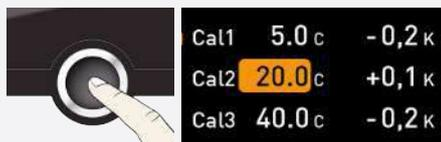
2. Pulse repetidamente el botón de confirmación hasta que se marque la temperatura de referencia Cal2.
