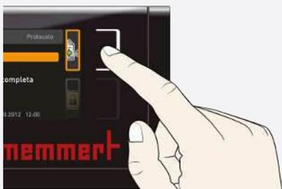
2. Pulse el botón de activación situado a la derecha de la indicación **Protocolo**.
