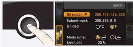
5. Confirme la nueva dirección IP después de configurar el último bloque de dígitos con el botón de confirmación.
