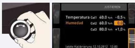
6. Ajuste el valor de corrección de ajuste a 0,0 %.
