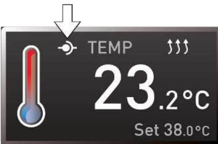
Cuando el equipo está en modo control remoto, esto se reconoce mediante el símbolo
