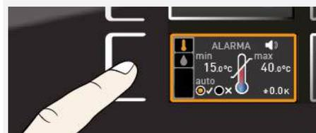
1. Pulse el botón de activación situado a la izquierda de la indicación **ALARMA**.
