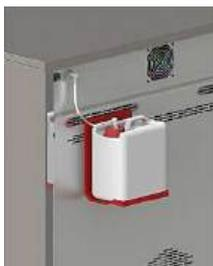
En el caso de los equipos de tamaño 750, el depósito de agua puede fijarse al equipo mediante el soporte para bidón suministrado. Para ello, enganche el soporte para bidón en las ranuras de la parte posterior del equipo. El soporte para bidón también cuenta con dos orificios a través de los cuales se puede fijar a la pared (material de fijación no incluido en el volumen de suministro).
