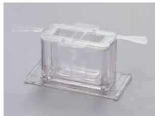
Recipiente pequeño de muestra (10 ml) Se utiliza al medir muestras de volumen pequeño.
