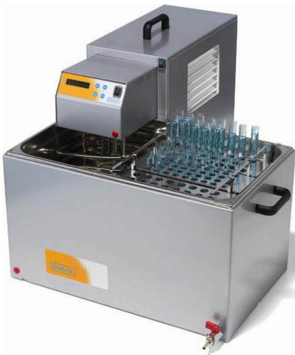
**Baño con Termostato de Inmersión Refrigerado Digital**, controlado por microprocesador.
