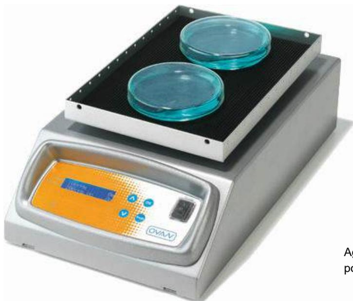
Agitador orbital digital, controlado por microprocesador.
