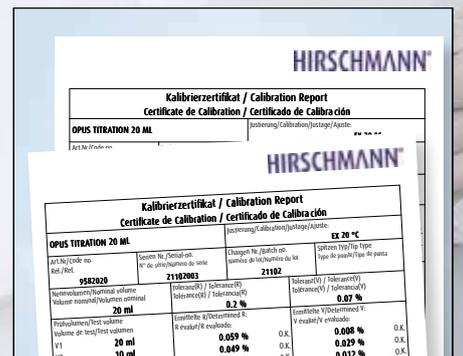
**El control de calidad da seguridad.** Control de calidad con certificado según DIN EN ISO 8655.
