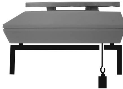
Imagen 1: Preparación de la balanza para pesaje bajo la base de la balanza.
