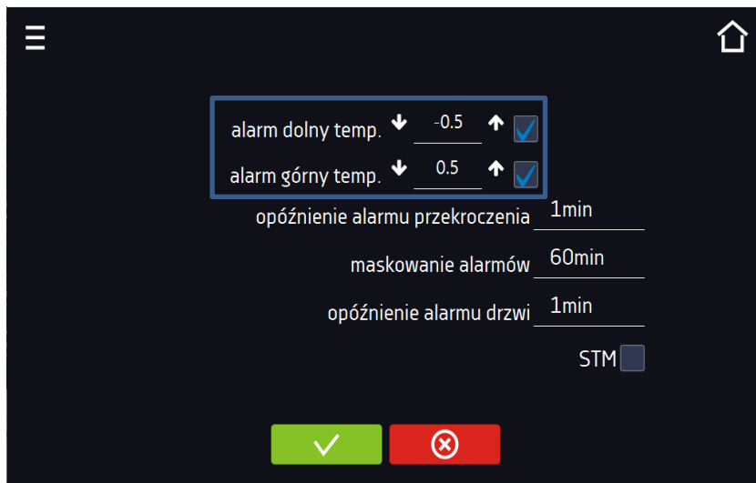
Rys.51. Alarmy przekroczenia parametrów
