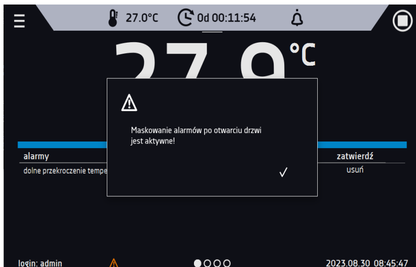
Rys.75. Włączone maskowanie alarmów
