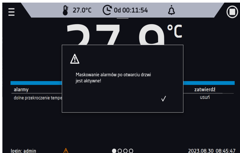
Rys.63. Włączone maskowanie alarmów
