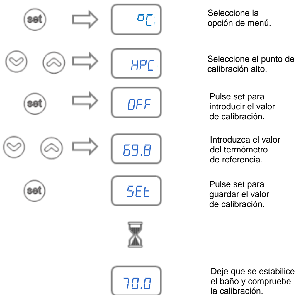
Figura 9 - Ajuste del punto de calibración alto
