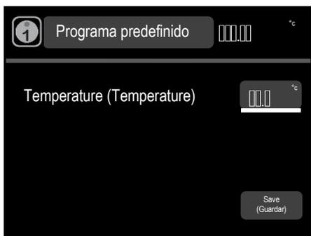
4. Cuando **Temperature** (Temperatura) esté resaltado, pulse el botón **S**. Gire el mando para definir la temperatura. Pulse **S** para realizar el ajuste.
