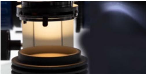
Eine bei der Durchlichtmikroskopie häufig genutzte Lichtquelle ist eine Halogenlampe. Diese ist preisgünstig und bietet abhängig von der Leistung eine hohe Lichtausbeute. Mittels Dimmer kann die für das Objektiv passende Lichtstärke eingestellt werden. Für die meisten Anwendungen ist eine Halogen-Beleuchtung ausreichend.
