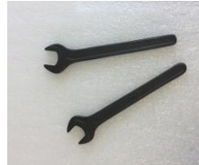
Clés pour mise à niveau du RM100 CP2000 PLUS
