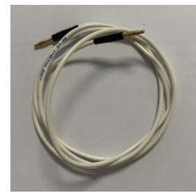
Cordon pour contact électrique entre cône-plan et plateau
