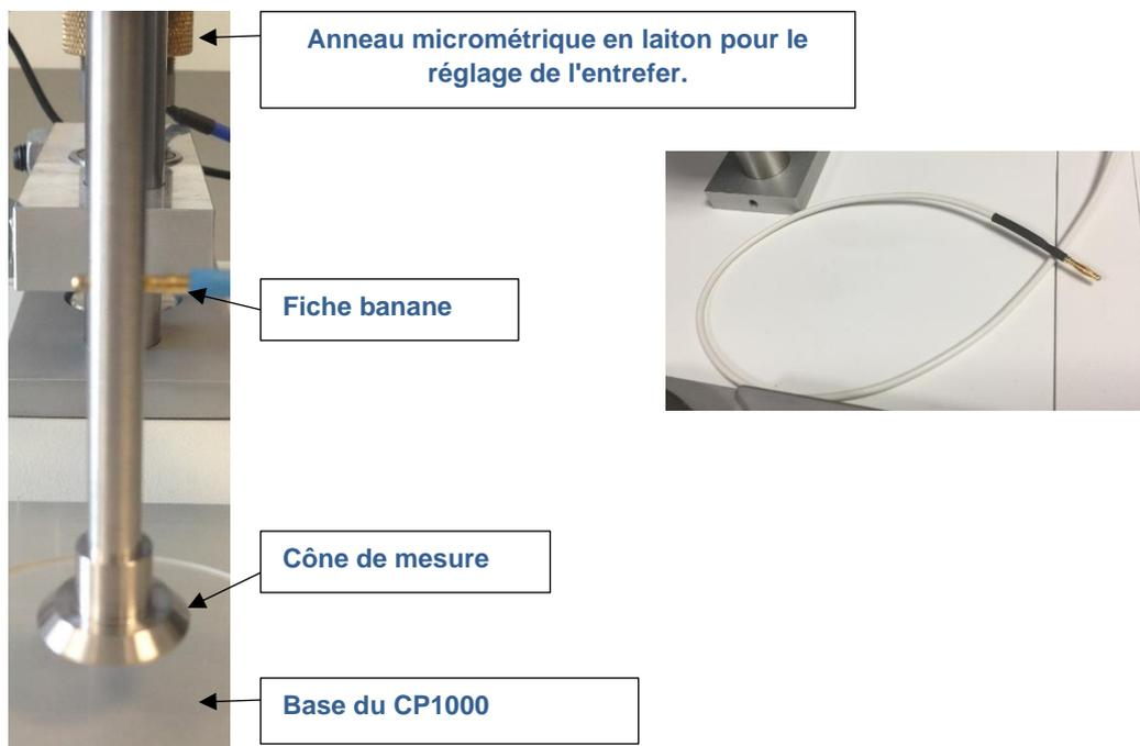
Abaissez le bras du RM 100 CP1000 PLUS en tirant sur le dispositif de verrouillage et en tenant la tête avec la poignée.
