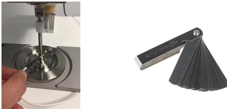
Lorsque vous utilisez un système de mesure MS-PP, vous devez régler de la même manière la position du contact comme expliqué précédemment. Mais la position de contact doit être effectuée en insérant une entretoise métallique (article en option 100047 comme indiqué sur l'image ci-dessus) entre le MS-PP et la plaque inférieure de 70 mm. Le choix de l'entretoise doit être fait en fonction de l'entrefer que vous souhaitez utiliser avec le système de mesure MS-PP.
