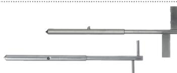
Pour votre information, seul le MK-KU1-10 est conforme à la norme ASTM D562. Pour obtenir l'unité KU pour votre mesure, vous devez choisir la broche de mesure MK-KU1-10 et la vitesse à 200 tr / min. Pour les autres vitesses et broches de mesure, vous obtiendrez une valeur de viscosité en Pa.s.
