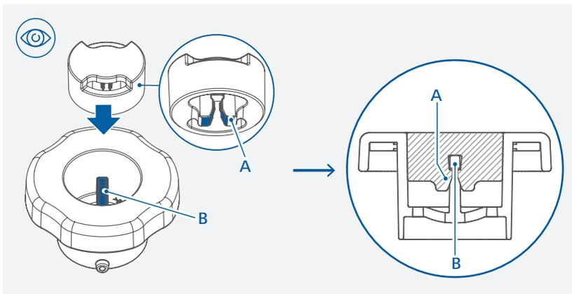
**Nota:** al montar la cubierta, asegúrese de que la cubierta de silicona se encuentre en la posición correcta.
