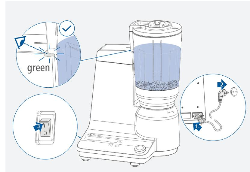
**Nota:** después de cerrar la tapa de forma segura, el color del LED indicador cambia de rojo a verde. El aparato no está listo para el funcionamiento hasta que el LED muestra una luz verde.
