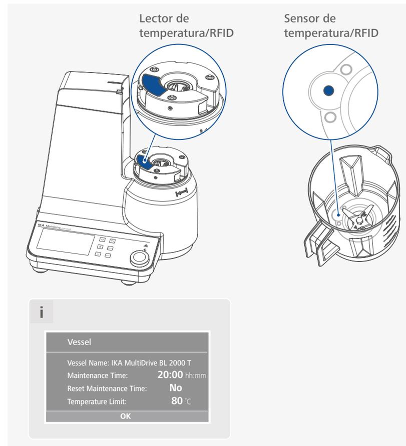
La medición de la temperatura con el recipiente **MultiDrive BL 2000 T** funciona exclusivamente con el **MultiDrive control**. Cuando se ajusta el límite de temperatura en el **MultiDrive control**, el aparato se detiene cuando se alcanza dicho límite. De este modo, este ajuste protege tanto la muestra como el recipiente contra un sobrecalentamiento.
