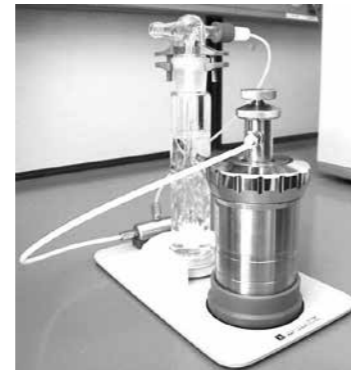
Entlüftung mit der Entlüftungsstation C 7030
