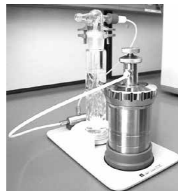
Dégazage à l'aide de la station de dégazage C 7030
